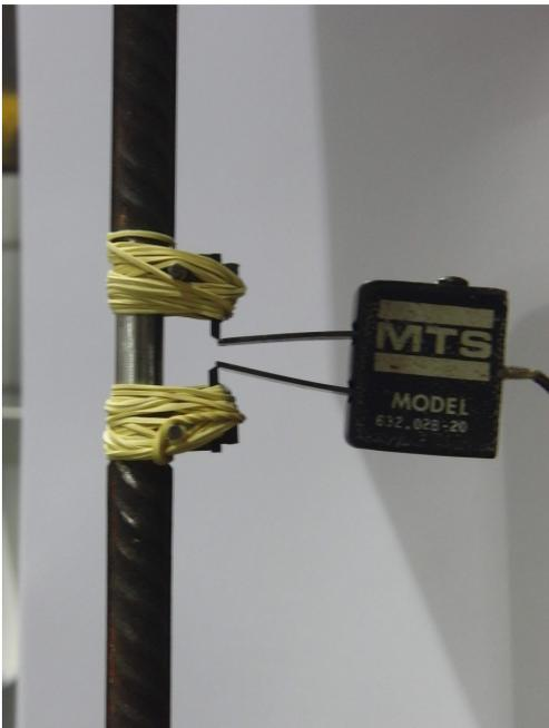
A barra de aço é fixada por garras em uma máquina de ensaio a tração. É posicionado um “clip gage” (vide figura) na barra, cuja função é medir alongamentos entre suas hastes, que são fixadas em dois pontos da barra.
