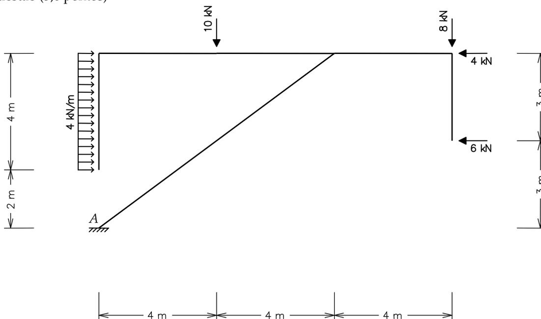
Teste: Determinação de Reações de Apoio
