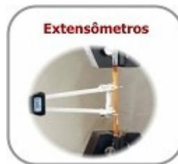
O ensaio de tração consiste em tracionar (estirar) a barra e anotar para cada valor de força aplicada ( $F$ ) o alongamento ( $\Delta$ ) entre as hastes do extensômetro. No ensaio realizado, a distância ( $L$ ) entre as hastes do extensômetro é de 100 mm.
