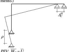
$\overline{W_F} \rightarrow \text{Trabalho das forças externas do sistema}$ virtual com os correspondentes deslocamentos externos do sistema real.
