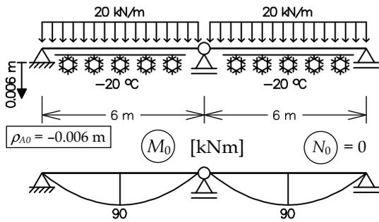
(Diagrama de momentos fletores do caso (0) só depende da força uniformemente distribuída aplicada, pois variação de temperatura e recalque de apoio não provocam esforços internos no SP isostático)
