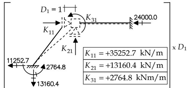
O caso (1) isola o efeito da deslocabilidade  $D_1$ , mantendo nulos os valores das deslocabilidades  $D_2$  e  $D_3$ . Conforme indicado na figura acima, a deslocabilidade  $D_1$  é colocada em evidência. Considera-se um valor unitário para  $D_1$ , sendo o efeito de  $D_1 = 1$  multiplicado pelo valor final que  $D_1$  deverá ter.
