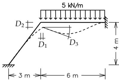
Todas as barras da estrutura do exemplo têm as mesmas propriedades elásticas e de seção transversal. O material adotado tem módulo de elasticidade  $E = 1.2 \times 10^7 \text{ kN/m}^2$ . A seção transversal das barras tem área  $A = 1.2 \times 10^{-2} \text{ m}^2$  e momento de inércia  $I = 1.2 \times 10^{-3} \text{ m}^4$ .
